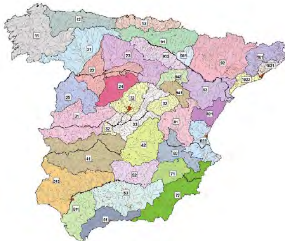
Figura 5. Rexións consideradas para a caracterización do coeficiente corrector do limiar de escorrentía (fig. 2.9 Instrución 5.2-IC).
